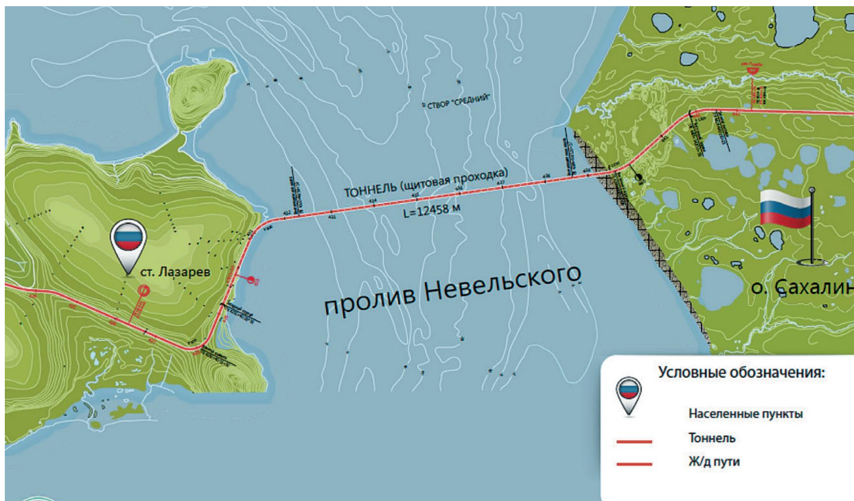
Рис. 4. Тоннельный вариант перехода через пролив Невельского
